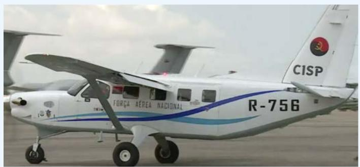
CISP (Centro Integrado de Segurança Pública) conta, desde Janeiro do corrente ano, com uma aeronave, modelo Quest Kodiak 100, uma turboélice de asa alta, não pressurizada, de monomotor, com um "trem" de pouso triciclo fixo e uma velocidade de aproximadamente 300 quilómetros por hora.
