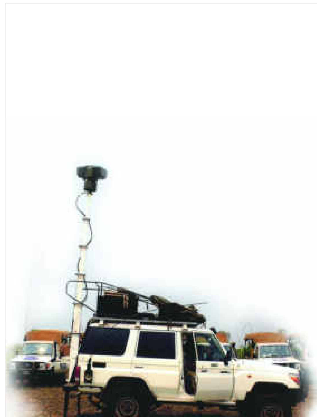
VEÍCULO DE PATRULHA DA POLÍCIA DA GUARDA FRONTEIRA. EQUIPADO COM O SISTEMA AUTO DE VIGILÂNCIA ELECTRÓNICA.
